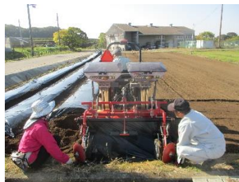
マルチャーで畝たて同時作業
